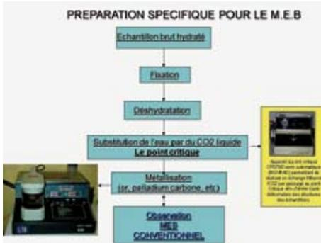
**Figure 5 :** Résumé de la technique pour le MEB conventionnel avec les étapes à suivre.
